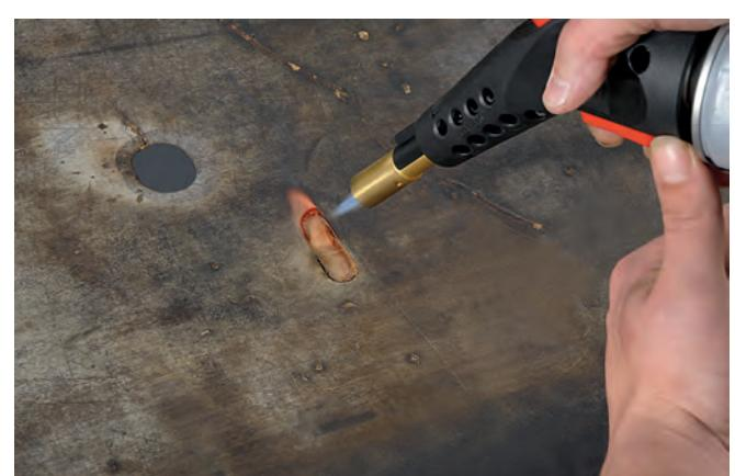
NOErepair eignet sich zum Regenerieren von NOEboard Schalbelägen sowie mehrschichtigen Sperrholz-Schalbelägen.
