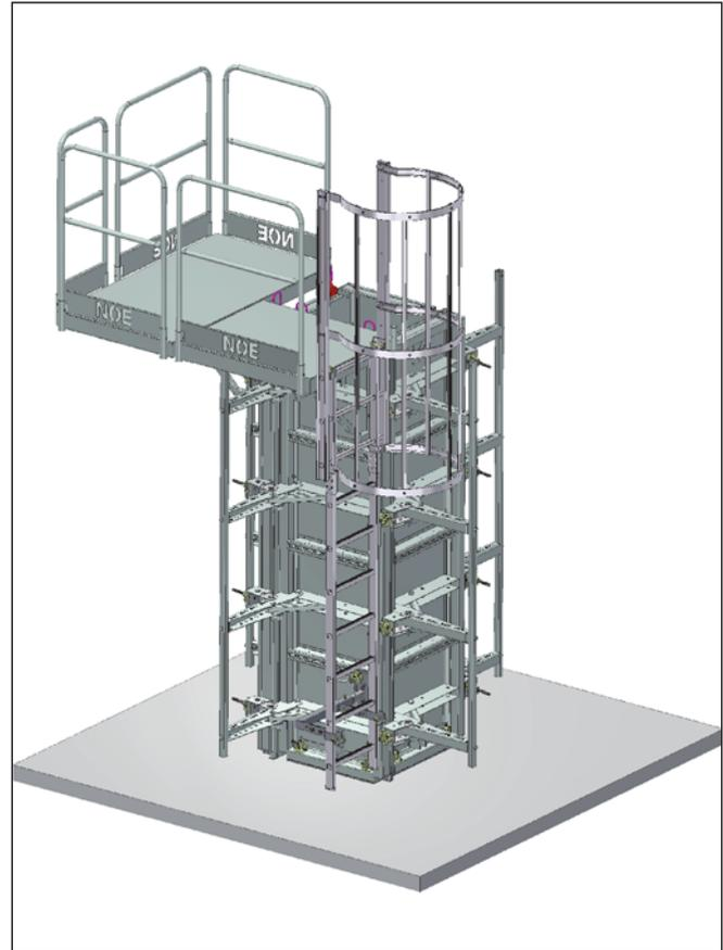
NOEtop FS permet de bétonner sans entretoisement des sections de poteaux de 200 à 600 mm. Les diamètres sont réglables sur une trame de 50 mm.
