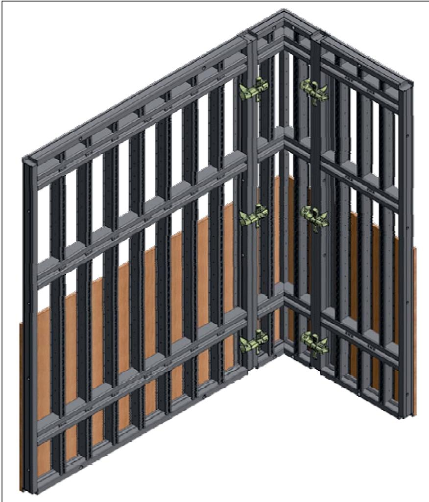
NOEtop R erweitert wesentlich das Einsatzspektrum des NOEtop Schal-systems. In die Schalroste mit integrierten Gurtungen sind Hutprofile mit Kunststoffleisten integriert. So ist es möglich, die Schalhaut unabhängig vom Schaltafelraster aufzubringen.
