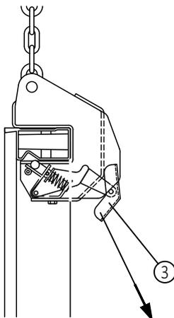
Den Sicherungshebel nach schräg unten ziehen. Der Sicherungsbolzen wird nach innen gedrückt und der Kranbügel kann von der Schalung gelöst werden.
