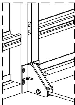
Gewindesockel mit Schraube M16x70 in das Fußlager einschrauben.
