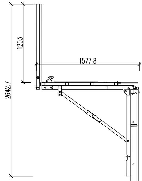
NOEtop Betoniergerüst Stahl 1325 mm
