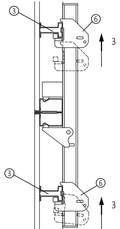
◆ Die beiden äußeren beweglichen Backen jeweils so an das Hutprofil schieben, dass sie die Profile umschließen
