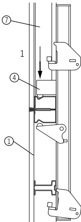
◆ Die Tafeln möglichst passgenau aufeinander stellen (bei liegendem Aufbau nebeneinander). Die Richtzwinge über den Schalungsstoß schieben und die starre Backe am Rahmen der Aufstock-Tafel anlegen. Dabei darauf achten, dass die Zwinge so eng neben dem Hutprofil der liegenden Tafel liegt, dass die Nase darin eingreift (siehe unten).
