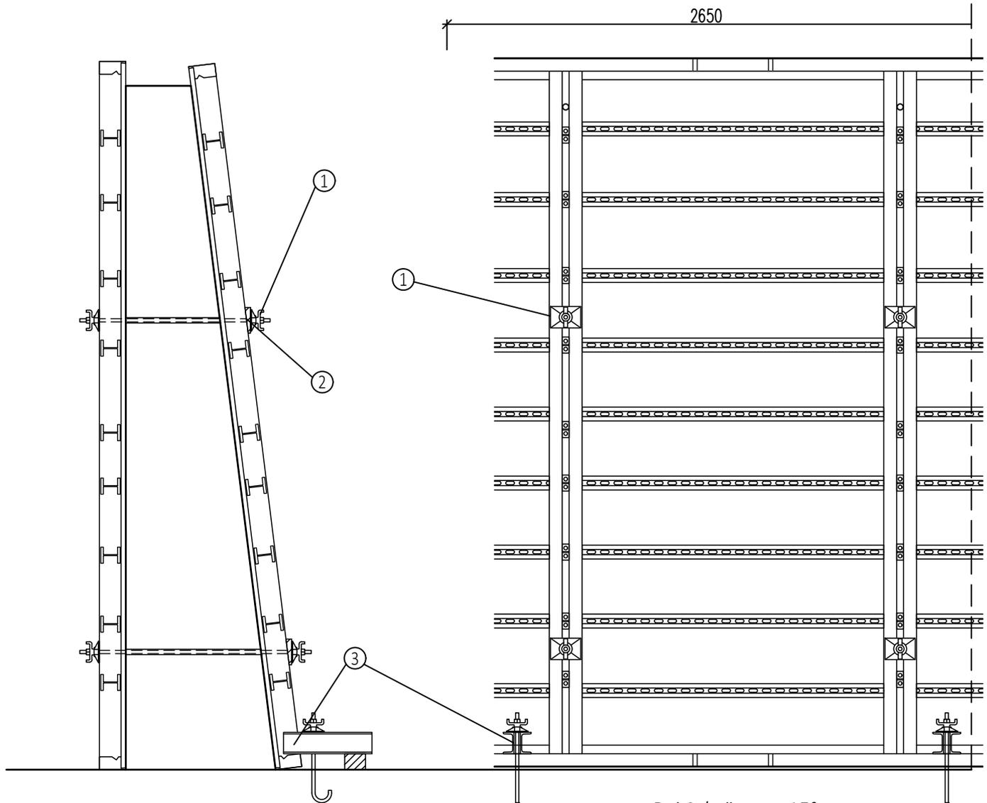
Der Ausgleich der Schräge bis 15° kann durch Hartholzkeile erfolgen, ansonsten mit der Schrägverspannungsplatte Teil-Nr. 164040.
