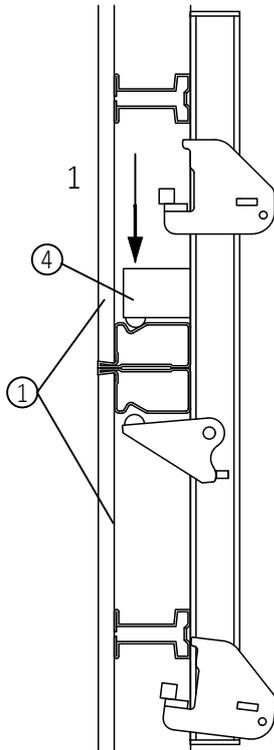
◆ Die Tafeln möglichst passgenau aufeinander stellen (bei liegendem Aufbau nebeneinander). Die Richtzwinge über den Schalungsstoß schieben und die starre Backe am Rahmen der Aufstock-Tafel anlegen.
