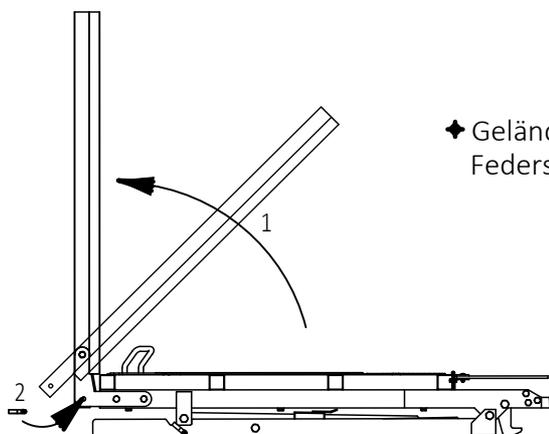
◆ Geländer hochklappen und mit Bolzen und Federstecker sichern.
