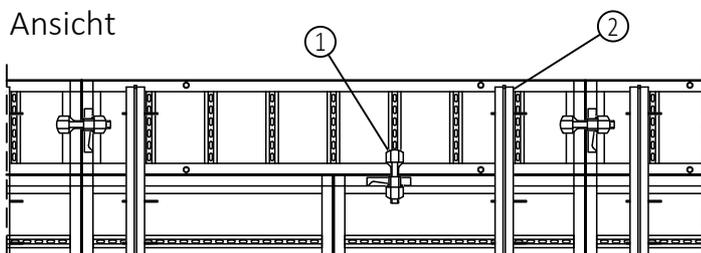
2 Richtzwinge und 1 Toplock auf Tafelbreite 2650 mm anordnen. Keine Verspannung der liegenden Tafel.
