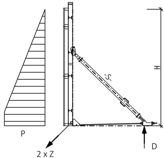
Zulässigen Betondruck und Ankerlast entsprechend der Betonierhöhe beachten!
