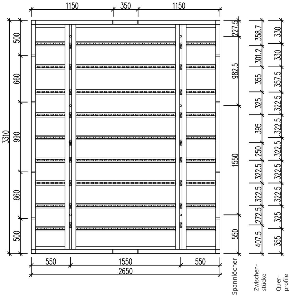
Detail Zwischenstück in integrierter Gurtung
