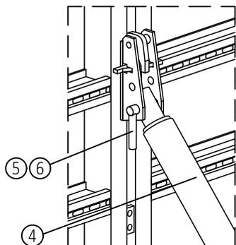
Kopflager in das Distanzstück der integrierten Gurtung bzw. der NOEtop Gurtung einhängen und Keil einschlagen.
