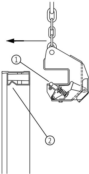
Den Kranbügel kräftig bis zum Anschlag über das Randprofil der Tafel schieben. Der Sicherungsbolzen wird dadurch nach unten gedrückt, fährt im Bereich der Sicke automatisch wieder heraus und sichert den Kranhaken.
