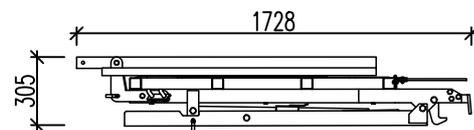
NOEtop Betoniergerüst Stahl 2650 mm mit Luke
