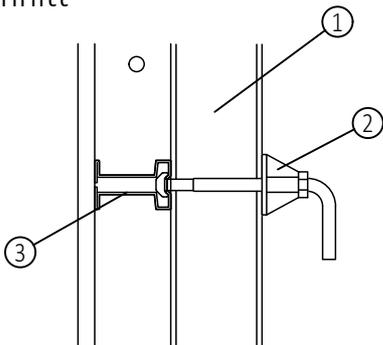
Die NOEtop Aufsatzgurtung wird mit Hammerkopfschrauben mit Griff in den Langlöchern des Hutprofils befestigt.
