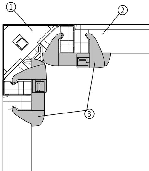
Die Ausschlecke wird mit dem NOE Toplock an die NOEtop Rahmentafel angeklemt.
