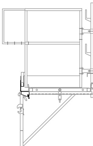
Stirngeländer an Laufgerüstkonsole und Geländerrohr angebaut.
