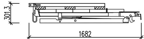
Clappbares Betoniergerüst 2650 mm mit Luke
