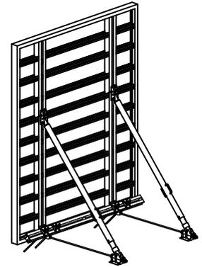
Dabei kommen NOEtop-Tafeln mit integrierter Gurtung (2650x2650 mm bzw. 3310x2650 mm) zum Einsatz. Alternativ können hinter Standardtafeln auch NOEtop-Aufsatzgurtungen angebracht werden, dies wird hier in der Variante II dargestellt.
