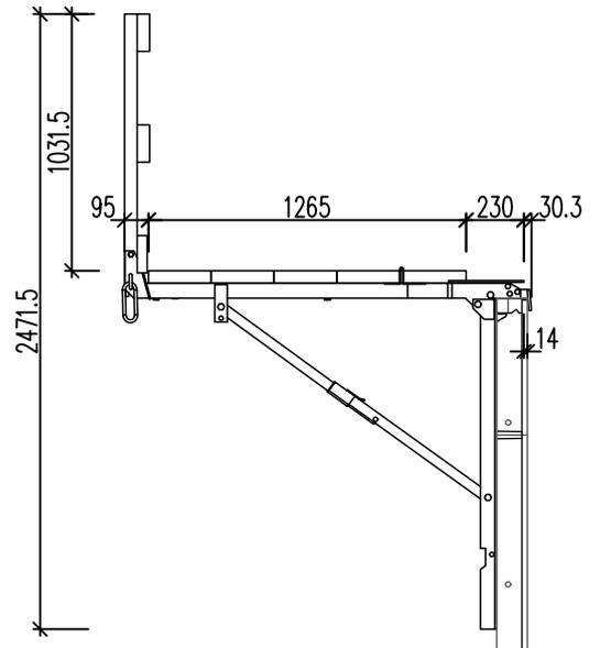
Clappbares Betoniergerüst 1325 mm
