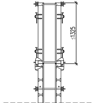
Zum großflächigen Umsetzen und Aufheben der Tafeln von der Montagefläche müssen für die Aussteifung zusätzlich Richtzwinge angebracht werden (s. unten).
