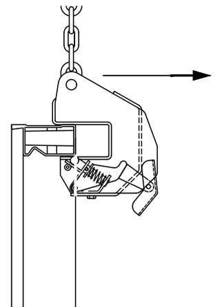
Um den Kranbügel vom Boden aus zu lösen, kann ein gebogener Draht in die Bohrung am Sicherungshebel eingeführt und gezogen werden.
