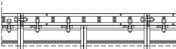
Tafelaufstockung mit Toplock. Aufstockung ohne Verspannung, wenn 3 Toplock auf die Tafelbreite von 2650 mm angeordnet werden.
