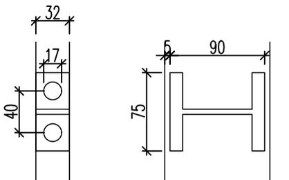
Schnitt integrierte Gurtung mit Darstellung Spannloch
