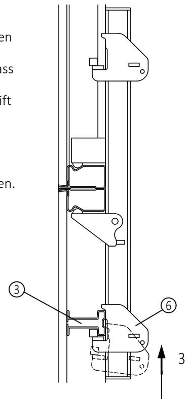
◆ Die untere bewegliche Backe so an das Hutprofil schieben, dass sie das Profil umschließt und Keil einschlagen.
