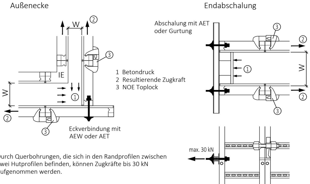
Abhängig von Betondruck und Wandstärke müssen zur Aufnahme der Zugkräfte u.U. mehr Schlösser angeordnet werden, als zur Tafelverbindung notwendig wären (siehe Tabelle).
