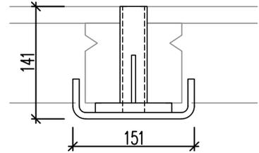
Zum Verspannen über der Schalung oder außerhalb des Spannloches, z.B. bei Fundamenten, Fensterausparungen, usw.
