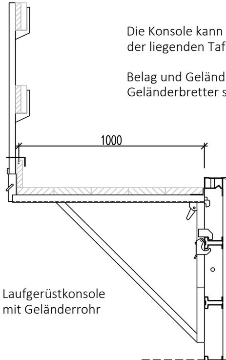
Die Konsole kann am Hutprofil der stehenden oder im Langloch des Hutprofils der liegenden Tafel eingehängt werden (siehe Aufbauanleitung).
