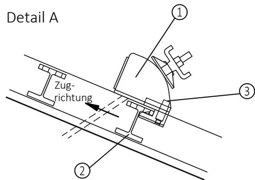
Schrägverspannungsplatte in das Distanzstück der integrierten Gurtung einhängen und einrasten lassen. Zugrichtung beachten. Zum Lösen Sperrknopf drücken und Platte aushängen.
