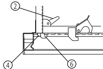
◆ Geländerrohr in die Konsole einstecken und mit Stecker sichern
