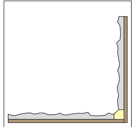
2 Eckprofil mit Fase auf Strukturhochpunkt im Beton
