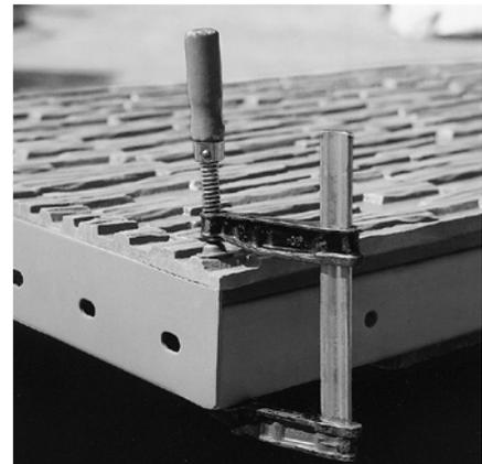
Werden die Matrizen später von Schalungen oder Kipptischen abgenommen und verbleiben Klebstoffreste auf der Schalfläche des Unterbaues, können diese nur mechanisch wieder entfernt werden. Dabei können auch die Matrizen beschädigt werden.
