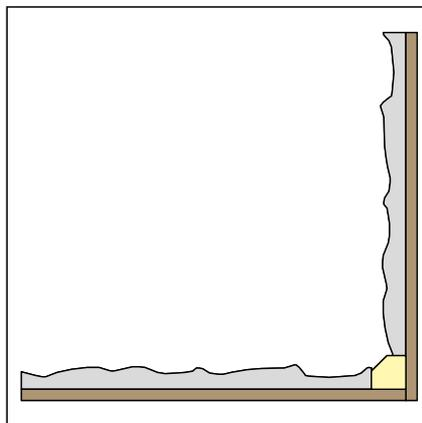
3 Eckprofil mit Fase auf Strukturmittelpunkt im Beton
