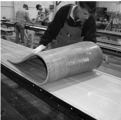
Nach vollflächigem Auftragen des Klebers die NOEplast Strukturmatrizen an der Längskante anlegen, auf der Schalunterlage abrollen und ohne Luftabschluss anpressen. Gegebenenfalls Ecken und Kanten beschweren.
