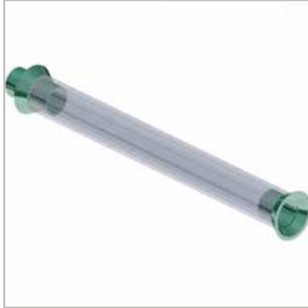
Sectionner la gaine à la bonne longueur, emboîter le cône de support et le cône de centrage
