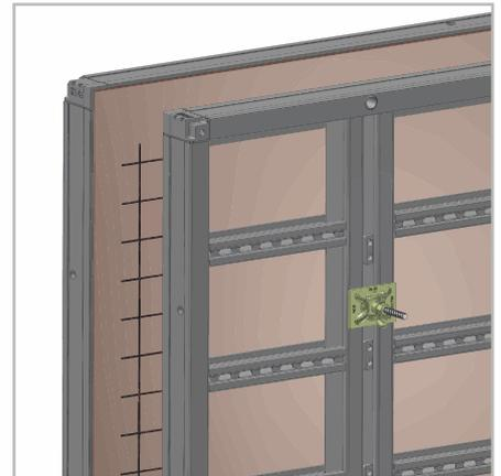
Appliquer la tige d'entretoise et monter la plaque d'ancrage avec écrou papillon
