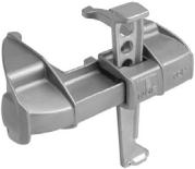
NOE Toplock<br>für Tafelverbindungen und<br>Längenausgleiche bis 42 mm,<br>zul. Zugkraft 15 kN, verzinkt                                                                                                                                                                         |             |              |            | 3,7               | <b>137976</b> |
